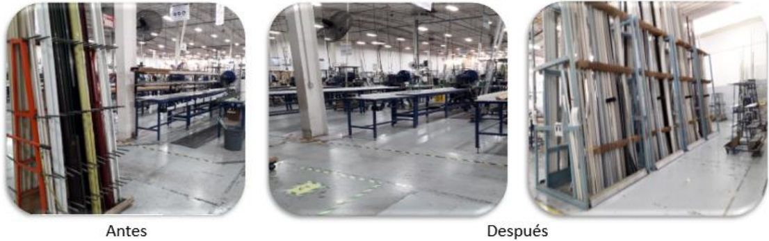
Figura 4.9: Antes y después del reacomodo de rieles a una área separada
